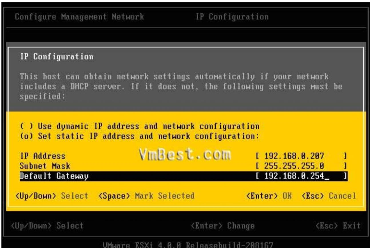
配置完成后，会提示复位网络，同意即可，同样可以设置DNS，回车后确认。以上即为ESXi的安装和配置。
